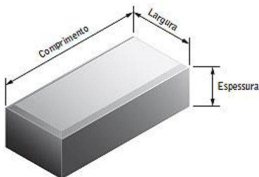
Será Assentado Piso em elementos pré-fabricados de concreto de concreto, com formato de Paralelepípedos que permite transmissão de esforços. Os Blocos serão assentados formando fiadas regulares, fortemente comprimidas por percussão. O Piso intertravado será executado, efetuando-se uma base de areia grossa com 8cm de espessura. O Terreno deverá estar previamente regularizado e apilado,
