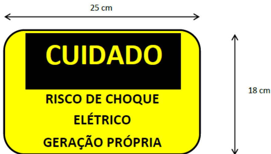
Figura 3: Placa de advertência e sinalização de Geração Própria.
