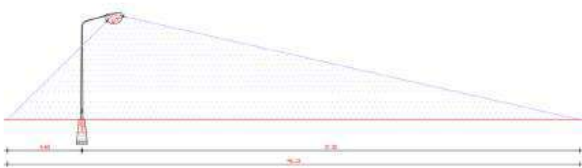
Figura 6: Projeção de área luminosa da lâmpada em questão dada as condições de instalação da mesma.
