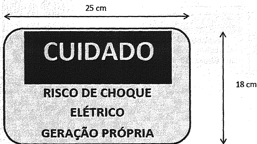
Figura 3: Placa de advertência e sinalização de Geração Própria.
