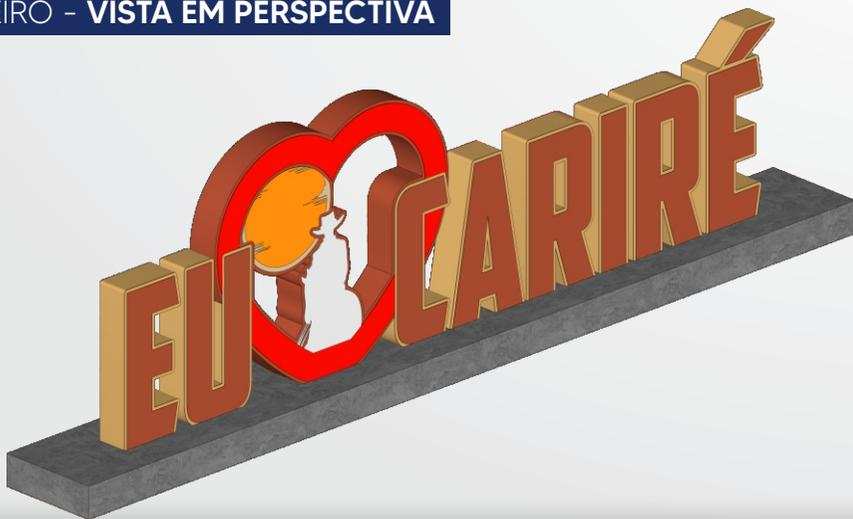
LETREIRO COM ESTRUTURA EM TUBOS METÁLICOS GALVANIZADOS REVESTIDOS EM ACM (ALUMÍNIO COMPOSTO) NAS CORES RESPECTIVAS AO PROJETO ILUSTRATIVO.
